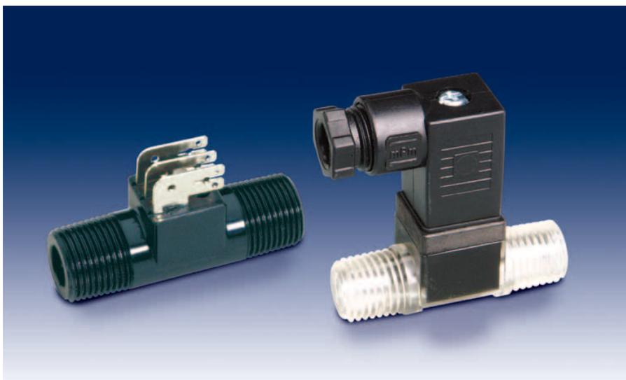
Gems TurboFlow<sup>®</sup> 涡轮流量传感器非常适合医疗设备低流量监控。小型涡轮具有开 / 关流量状态快速响应特征。该功能结合低成本和 0.5% 可重复性, 使 TurboFlow<sup>®</sup> 传感器成为配料调速系统的理想替代产品。与现有调速系统不同, 成熟的涡轮技术不会受到过滤器老化导致的系统压力变化的影响。每件传感器都进行全面检测, 确保使用年限。该系列传感器采用标准电源和输出规格使其能非常轻松地取代现有控制器。
