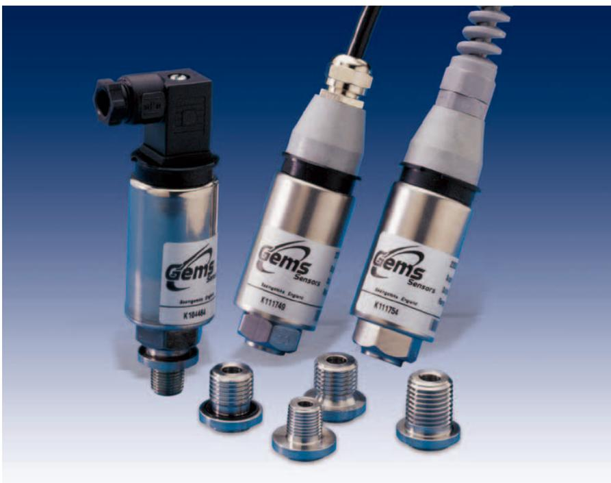
Gems 2200 系列压力变送器采用成熟的“化学气相沉积”（CVD）传感技术，在宽工作温度范围内具有长期稳定性和出色的精度。接触液体部件采用全不锈钢构造，确保与医用气体和腐蚀性液体的兼容性。丰富的压力和电气配件使其可与现有系统直接搭配。
